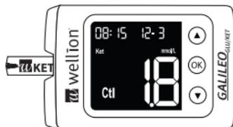
Schritt 8: Entfernen Sie den gebrauchten Teststreifen indem Sie die Auswurfaste betätigen (falls vorhanden) oder ihn manuell herausziehen. Entsorgen Sie den Teststreifen ordnungsgemäß. Das Messgerät schaltet sich beim Entfernen des Teststreifens oder nach 2 Minuten Inaktivität automatisch ab.
