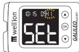
Schritt 4: Einstellen des Tages: Der aktuell eingestellte Tag blinkt. Wählen Sie den korrekten Tag mit Hilfe der Pfeiltasten aus. Bestätigen Sie Ihre Wahl durch Drücken der OK-Taste und fahren Sie mit dem Einstellen des Jahres fort.
